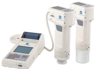
Figura 2. Colorímetro Minolta.
