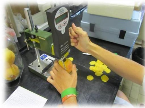
Figura 5. Penetrómetro manual Magness-Taylor.
