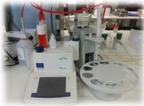
**Figura 7.** Valorador automático Mettler Toledo G20 Compact Titrator.
