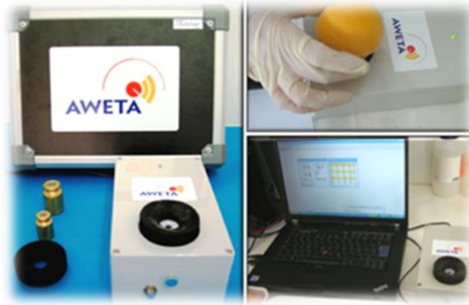
**Figura 3.** Medidor de firmeza por impulso acústico, AWETA.
