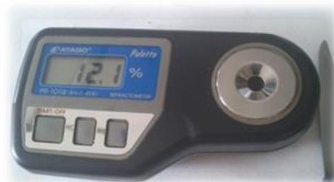
Figura 6. Refractómetro digital ATAGO PR 101.
