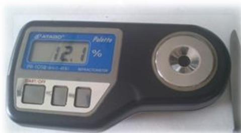
**Figura 6.** Refractómetro digital ATAGO PR 101.
