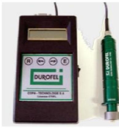
**Figura 4.** Medidor de firmeza no destructiva, DUROFEL.
