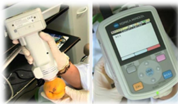
Figura 1. Espectrofotómetro CMS 700 de Konica Minolta.
