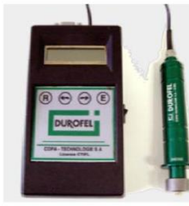
Figura 4. Medidor de firmeza no destructiva, DUROFEL.
