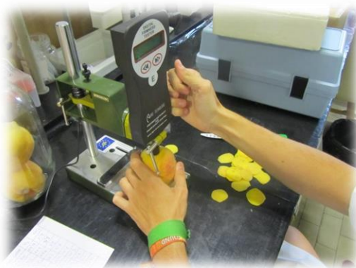
Figura 5. Penetrómetro manual Magness-Taylor.
