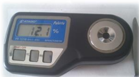
Figura 6. Refractómetro digital ATAGO PR 101.
