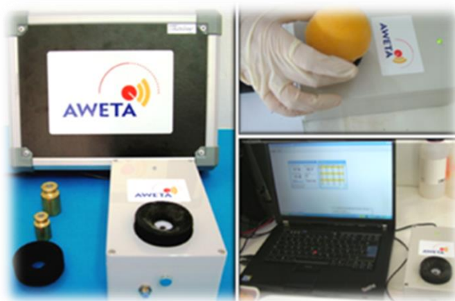
Figura 3. Medidor de firmeza por impulso acústico, AWETA.
